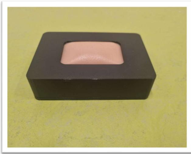
SIMULATORE PENSATO PER L'INSERIMENTO DI MICROCHIP COMPOSTO DA UN PAD IN GOMMA SILICONICA INSERITO IN UN APPOSITO SUPPORTO REALIZZATO IN STAMPA 3D, CHE NE GARANTISCE LA FISSITÀ, MANTENENDO IL PAD "SOSPESO" PER UN INSERIMENTO
