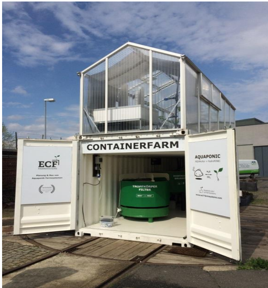
Prototype van de verpakking boerderij getest door Efficient Stad Landbouw (ECF) met aquacultuur in container en hydrocultuur in kas. DOOR ECF Farmsystems Berlijn
