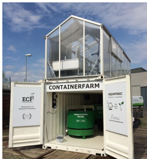
Prototyp der Container-Farm getestet von Efficient City Farming (ECF) mit Aquakultur in Container und Hydroponik im Gewächshaus. Von ECF Farmsystems Berlin
