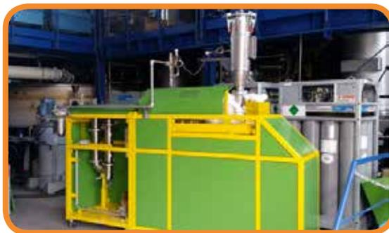
Fig. 3 – Termoreforming Catalitico sviluppato da TERMOREF
