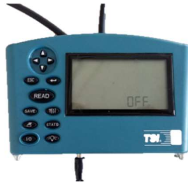
Manometro differenziale TSI DP-Calc™ Micromanometer 8710
