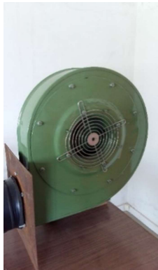
Ventilatore regolato tramite inverter
