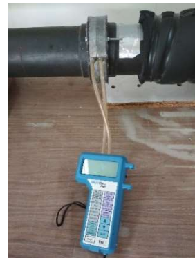
Orifizio tarato con manometro differenziale
