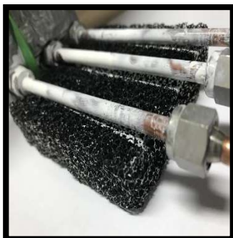
Scambiatore con pasta termoconduttiva
