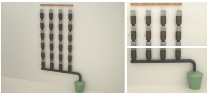
*Figura 2. Struttura di base dei sistemi verticali con bottiglie.*
