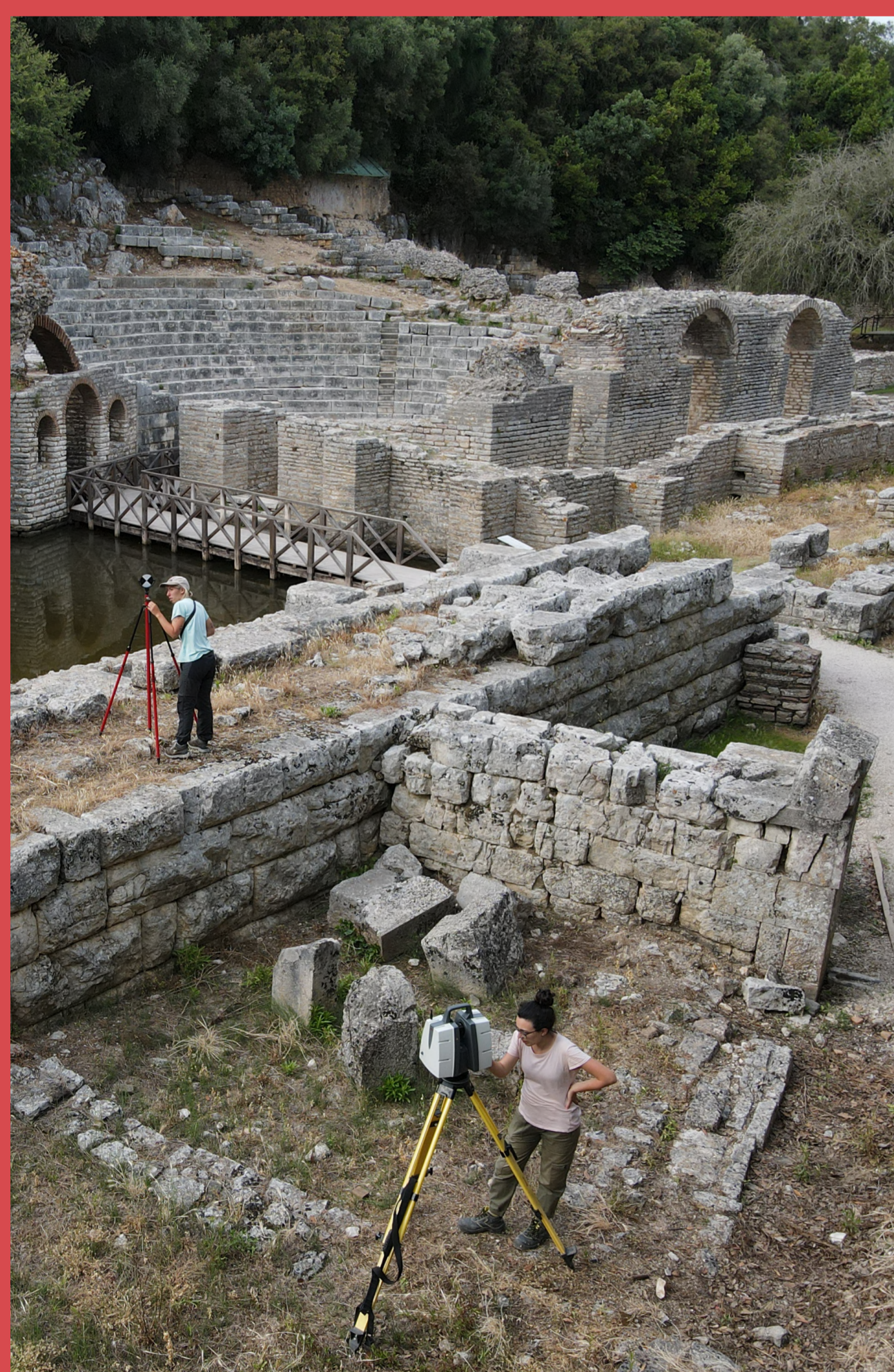
Fig. 3 Rilievo tramite laser scanning del Santuario di Asclepio.
