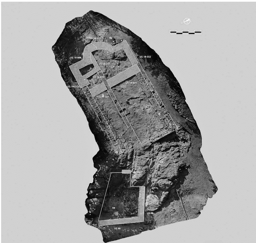
Fig. 4 edificio a base rettangolare di epoca tardoantica (torre, poi casa torre medievale), con muri in conci di pietra della brachisinclinale, su cui è stata realizzata in epoca medievale una chiesa, con abside incisa nella roccia. Elab. G. Rivaroli
